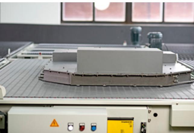
Die Unterstützung der EV-Batteriemodule über die gesamte Grundfläche ist ein entscheidender Vorteil der DARB-Technologie
