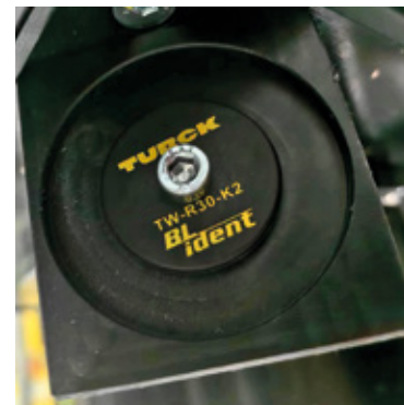
Der TW-R30-K2 gewährleistet mit 10 Milliarden Schreibvorgängen auch auf Dauer eine sehr gute Lesbarkeit
