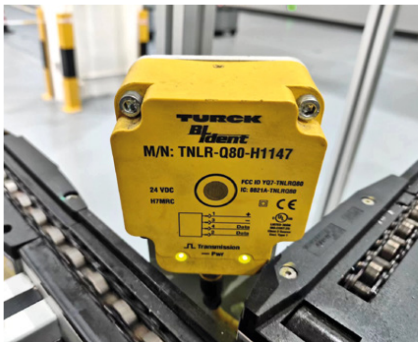
Turcks robuster HF-Schreib-Lese-Kopf Q80 ermöglicht dank hoher Reichweite die zuverlässige RFID-Erkennung – auch bei Positionsabweichungen der Datenträger
